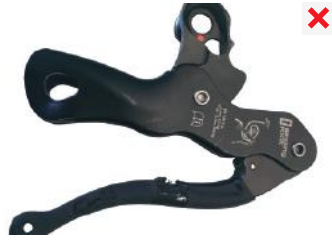
daño en palanca
