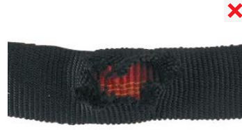
daños en la construcción
