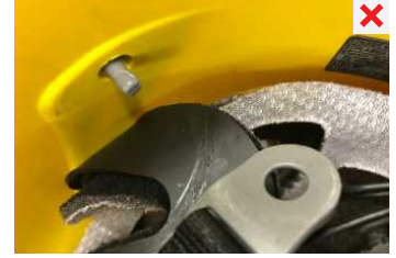
daño en la unión entre carcasa y barboquejo
