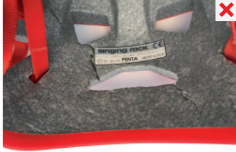
Daño en la estructura del amortiguador de casco
