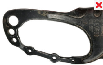
pérdida de asa
