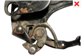
corrosión - funcionalidad limitada
