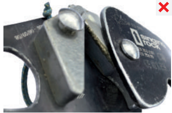
pérdida de material
